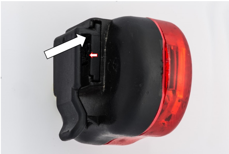
Figure 27: Pour enlever le clip mâle de la lampe: mouvement de la pièce (flèches noires), soulever la languette (flèche rouge).
